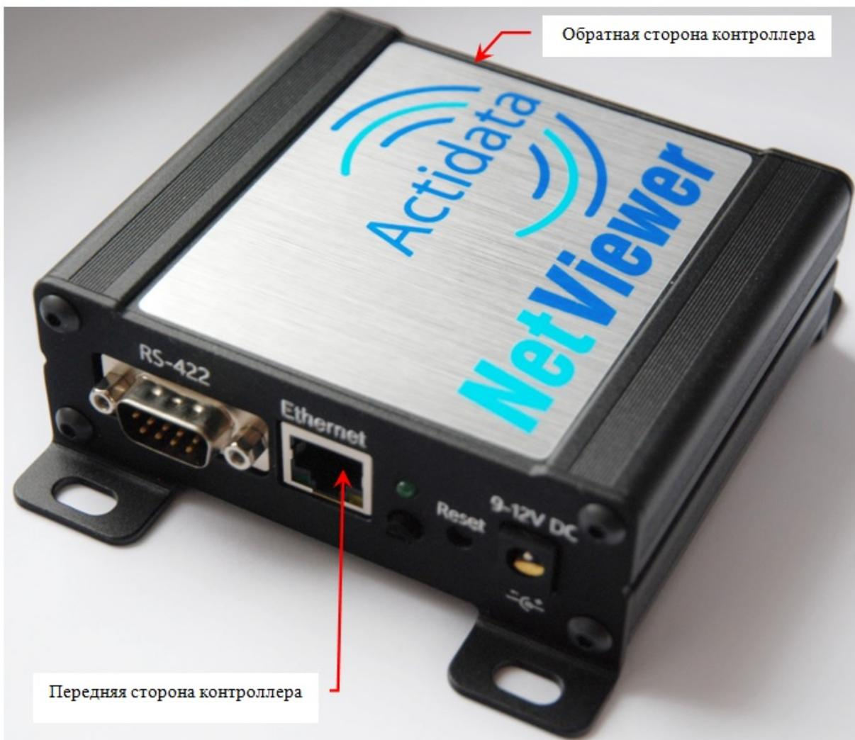
Рисунок 1. Внешний вид контроллера **Actidata NV1.1**
