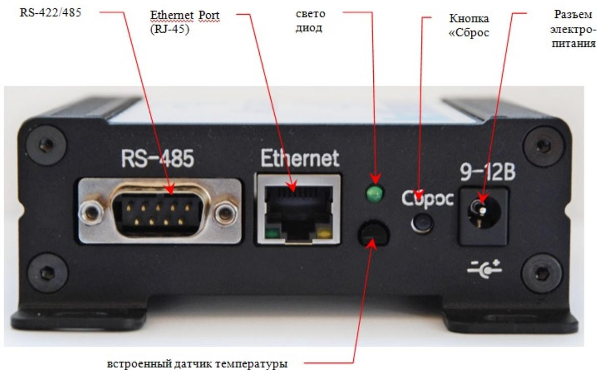
Рисунок 2. Вид разъемов на передней стороне контроллеров **Actidata NV1.1**
