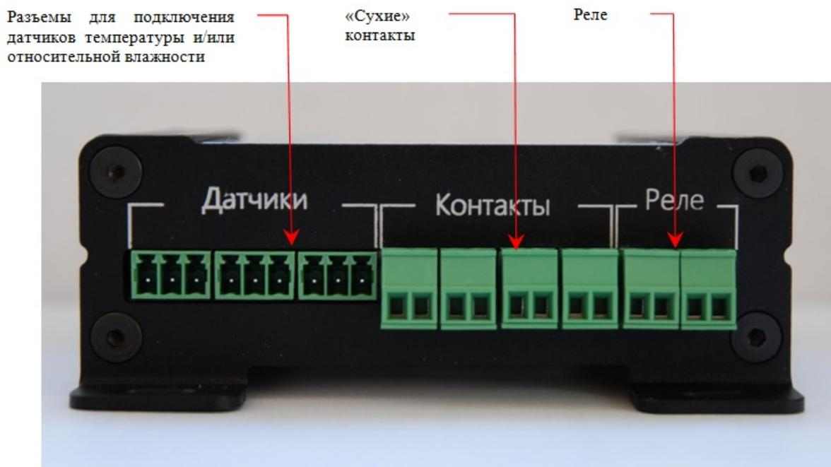
Рисунок 3. Вид разъемов с обратной стороны модели контроллера **Actidata NV1.1**
