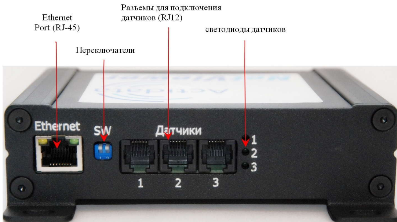
Рисунок 2. Вид разъемов на передней стороне контроллеров Actidata NV2
