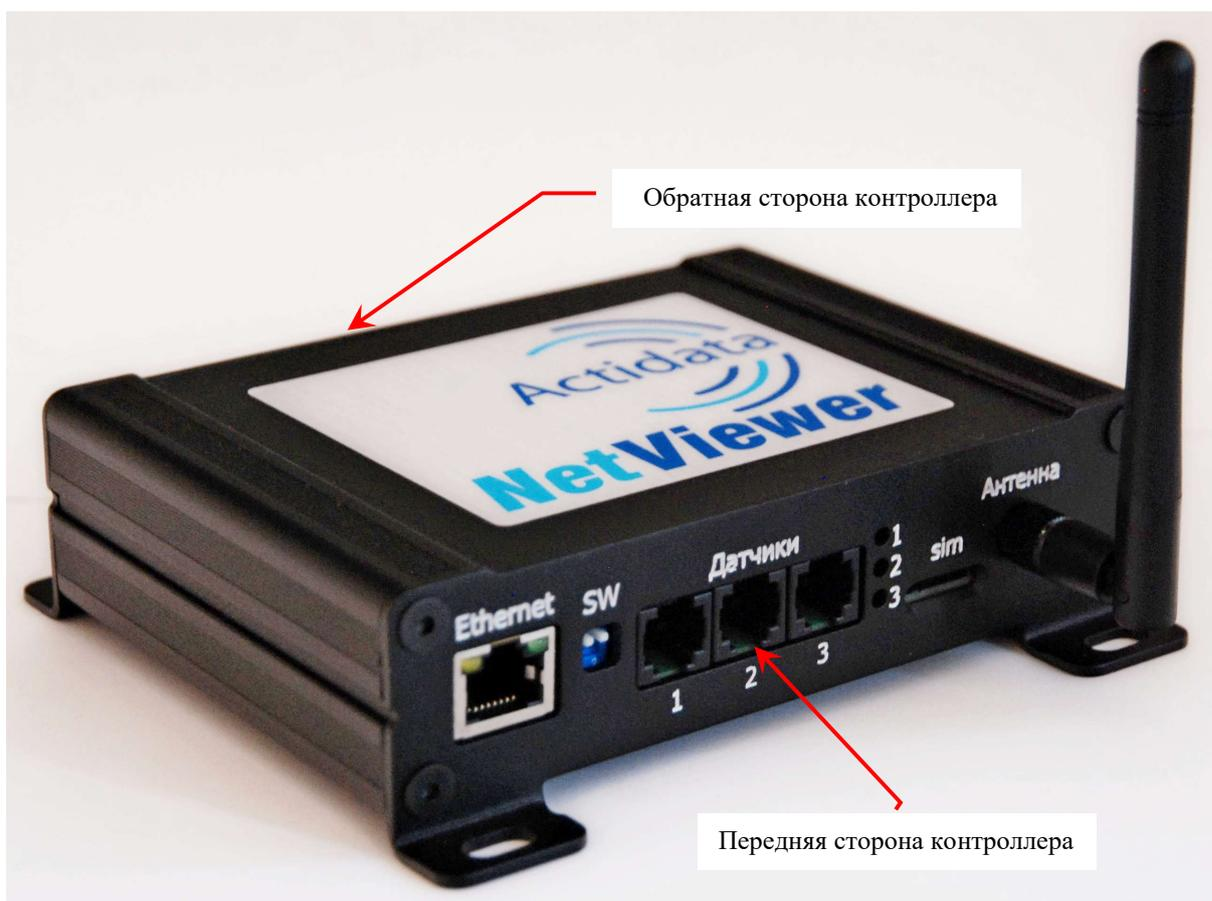
**Рисунок 1. Внешний вид контроллеров Actidata NV 3**
