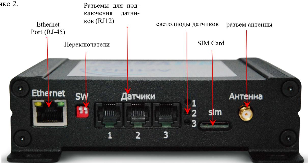
**Рисунок 2. Вид разъемов на передней стороне контроллеров Actidata NV 3 с GSM-модемом**
