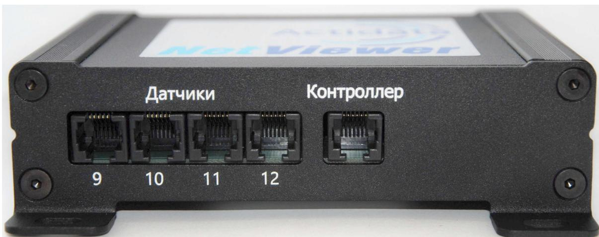
*Рисунок 5. Вид разъемов с обратной стороны разветвителя для датчиков температуры/влажности/напряжения*
